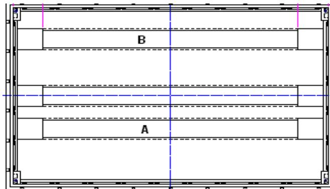
Il supporto basso (B) deve essere alloggiato nella guida esterna in alto e quello più alto (A) deve essere alloggiato nella guida in basso per permettere il passaggio delle tubazioni.
